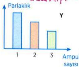
Yandaki grafiklerde özdeş ampuller kullanarak hazırlanmış X ve Y devrelerinde ampul sayısı – her bir ampulün parlaklığı arasındaki ilişki gösterilmiştir.
